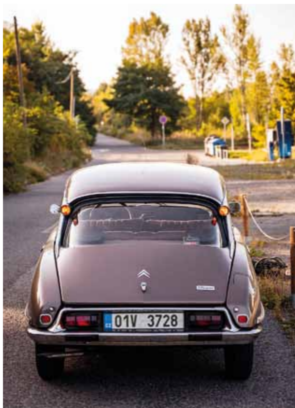
BLIKAČE Zadní ukazatele směru jsou netradičně umístěné téměř ve velikosti horního okraje okna, tím lépe jsou však pro ostatní účastníky provozu viditelné
