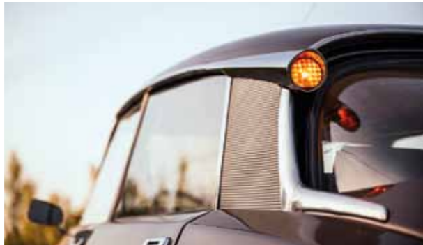
BLIKAČE Zadní ukazatele směru jsou netradičně umístěné téměř ve velikosti horního okraje okna, tím lépe jsou však pro ostatní účastníky provozu viditelné
