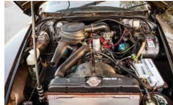
DVA LITRY POHODY Čtyřválec o výkonu 72 kW má sice původ už v třicátých letech minulého století, pro pohodový přesun korábu však stále stačí
